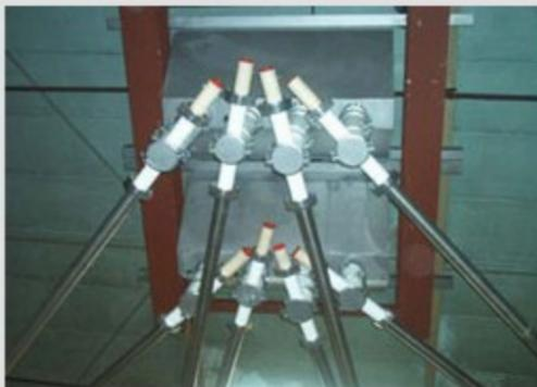
Bei der Sternförderung wird aus einem oder mehreren Vorlagebehältern das Material sternförmig auf die Maschinentrichter transportiert. Die Vorwahl der jeweiligen Materialien zu den Maschinentrichtern erfolgt über ein Auswahlm Menü in der Steuerung.
