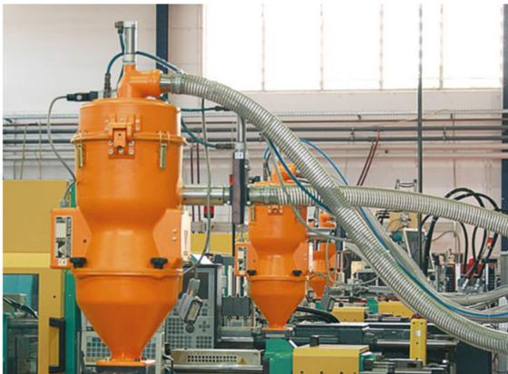
Materialabscheider A8 mit Zwischentrichter Z5 in einer zentralen Förderanlage
