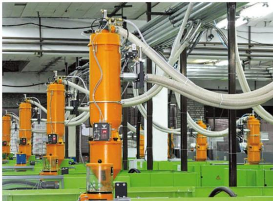
Förderabscheider TMA30 und TMA20 mit Zwischentrichter Z12
